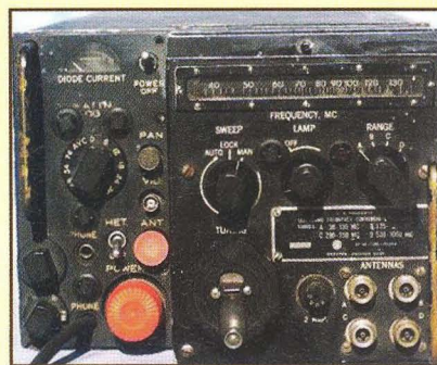
Obr. 1. Přijímač APR-4 s přepínatelnými rozsahy 40 – 4000 MHz byl používán americkým letectvem k radioelektronickému průzkumu
