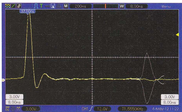
Obr. 4. Odraz od konce UTP kabelu (DSO5202B)
