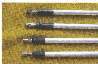
Obr. 4. Upravené konce teleskopických prvků (bez stahovací s-pásky). Zde jsou spodní konce zanytovány, horní konce zalisovány a přetaženy samosmršťovací bužirkou (viz též obr. 5 a 6)
