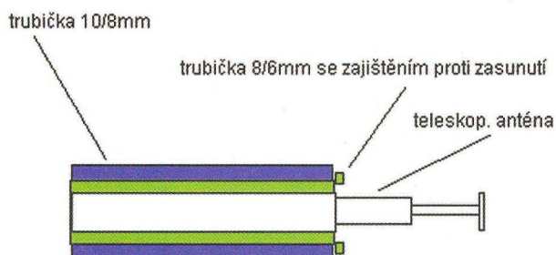
Obr. 6. Horní konec prvku; teleskopy buď zalisujeme a přetáhneme bužirkou, nebo na stažení použijeme s-pásku na hadice
