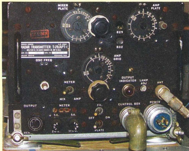
Obr. 2. Rušič radarů APT-1 Dina. Vyráběn v r. 1942. Pracovní rozsah 90 – 220 MHz. Výstupní výkon 12 W (vlevo)
